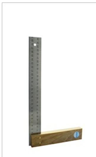
Dwustronna i dwustronna skala milimetrowa na blasze stalowej
