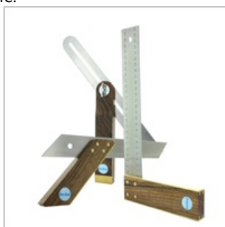
Wyciągnięta, odporna na ścieranie skala milimetrowa po obu stronach stalowego języka
