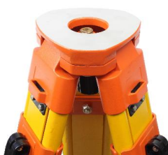
Passagem para um feixe de prumo óptico
