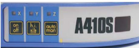
**6** Kalibrieren Sie jetzt die Y-Achse, drücken Sie die Taste
