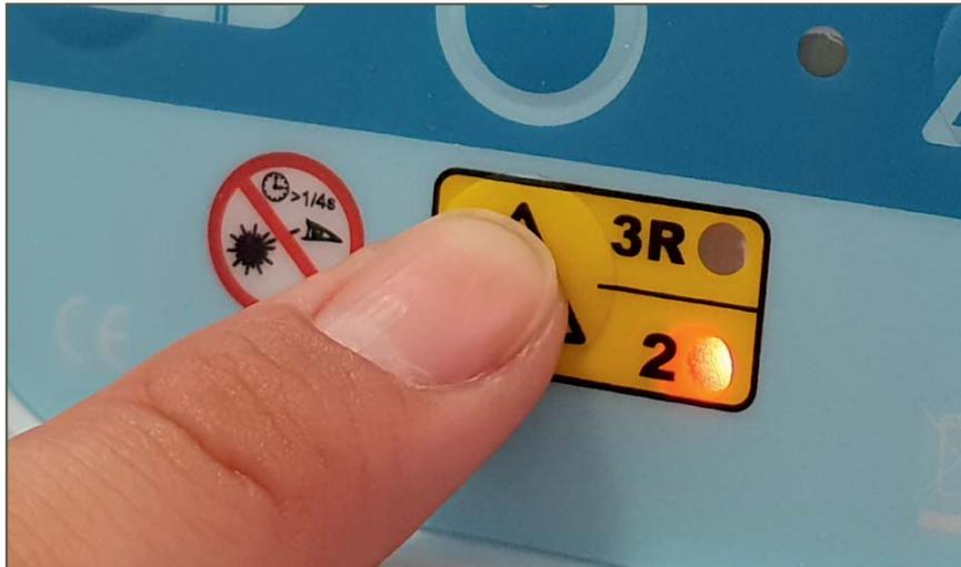
Die Rotationslaser hedue Q3 und Q3G können sowohl in Laserklasse II als auch in Laserklasse 3R betrieben werden. Die Laserklasse 3R erlaubt eine höhere Lichtleistung, d.h. eine stärkere Emission von Laserstrahlung. Daher ist der Laserstrahl in der Laserklasse 3R besser sichtbar als in der Laserklasse II.
