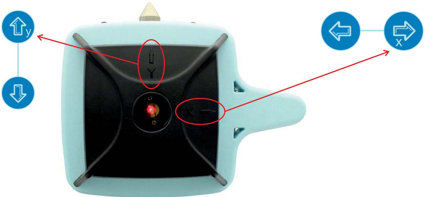
Die Richtung der Achsen ist auf der Oberseite des Rotationslasers angegeben. Jeder Achse ist ein Tastenpaar zugeordnet. Die Tastenpaare sind ebenfalls mit X und Y beschriftet.
