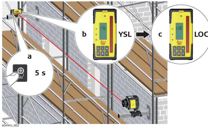
Utiliser la fonction Smart Target du détecteur pour aligner et surveiller automatiquement le faisceau laser. Presser le bouton Laser man du détecteur durant 5 secondes pour démarrer l'alignement, l'acquisition de pente et le verrouillage/la surveillance. Le détecteur affiche **YSL**, puis **LOC** à la fin de l'opération.
