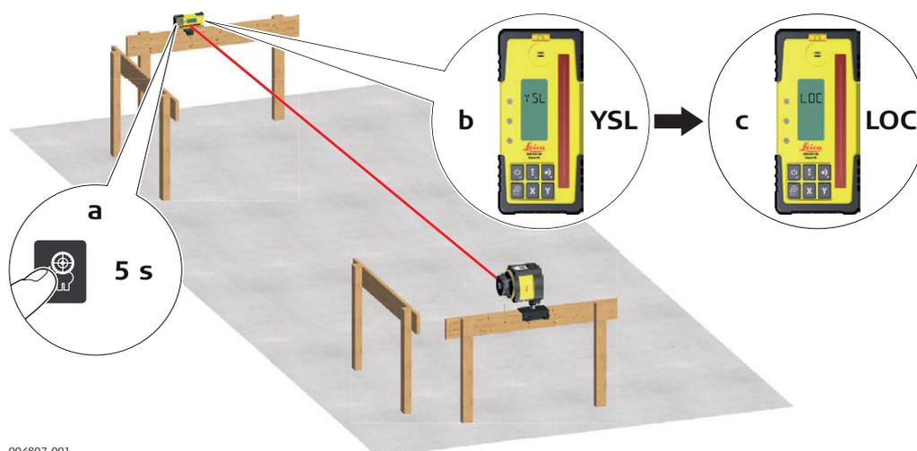
Utiliser la fonction Smart Target du détecteur pour aligner et surveiller automatiquement le faisceau laser. Presser le bouton Laser man du détecteur durant 5 secondes pour démarrer l'alignement, l'acquisition de pente et le verrouillage/la surveillance. Le détecteur affiche **YSL**, puis **LOC** à la fin de l'opération.
