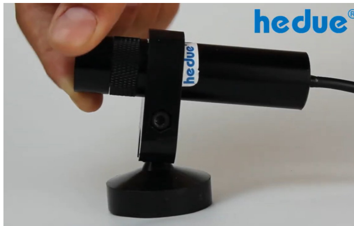
Obr. 3: Zaostření otáčením přední vroubkované části laseru
