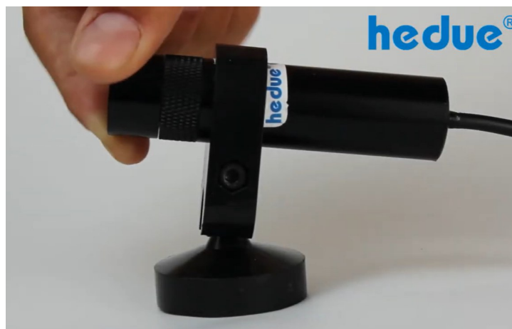
Fig. 3 : Mise au point en tournant la partie avant moletée du laser
