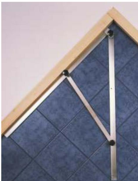
Grosswinkel in 45° bei der diagonalen Verlegung von Bodenbelägen
