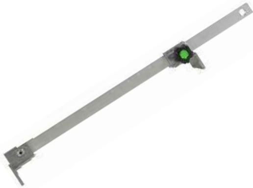
Das Lattenstichmaß aus Aluminium erleichtert das Aufbringen der Dachlattung und ist einfach und bequem in der Handhabung. Die aufgebrachte Millimeterskala von 50 bis 400 mm ermöglicht Dachlattungen für Dachziegel, Dachpfannen und Biberschwanzdeckung im Handumdrehen. Der Anschlag ist auf der gesamten Länge stufenlos verstellbar und durch eine Feststellschraube leicht zu arretieren. Die Bohrung am Kopf des Lattenstichmaß erlaubt die Verbindung mit einer Fallsicherung.
