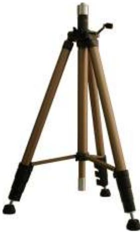
Das kompakte Kurbelstativ 1085 hat einen Verstellbereich von 0,75 m bis 2,86 m. Eine schnelle und präzise Höheneinstellung Ihrer Geräte ist dank des 32 cm Kurbelhub und des 56 cm Teleskophub problemlos machbar. Mit einem Gewicht von 3,5 kg trägt das Stativ sowohl Linienlaser als auch schwerere Rotationslaser problemlos.
