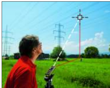
M surare indirect a în limii i în exterior.
