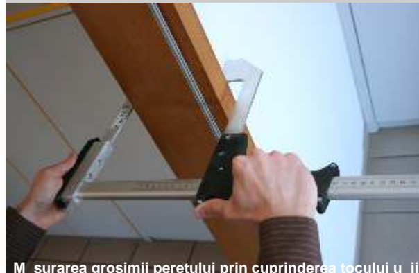
M surarea grosimii peretelui prin cuprinderea tocului u ii
