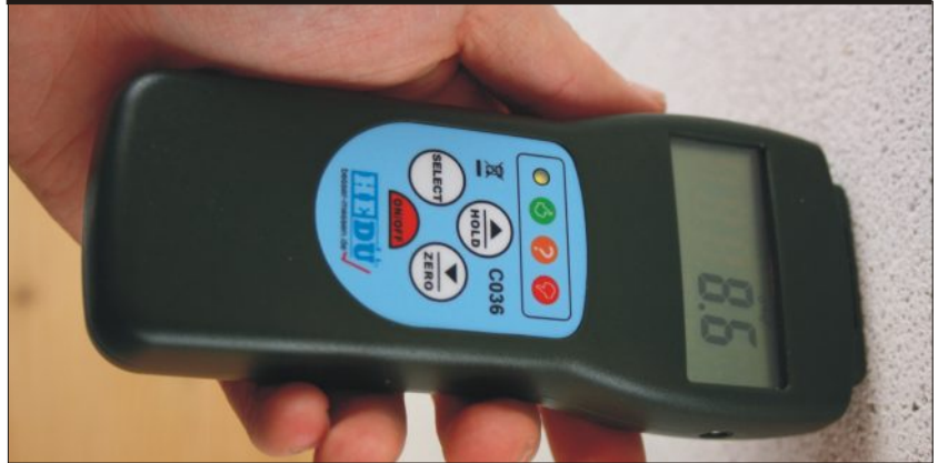
2 w 1: Wilgotno ciomierz oferuje w zestawie czujnik igłowy (rysunek u góry) oraz bezinwazyjn (nieniszcz c ) sond (rysunek na dole).
