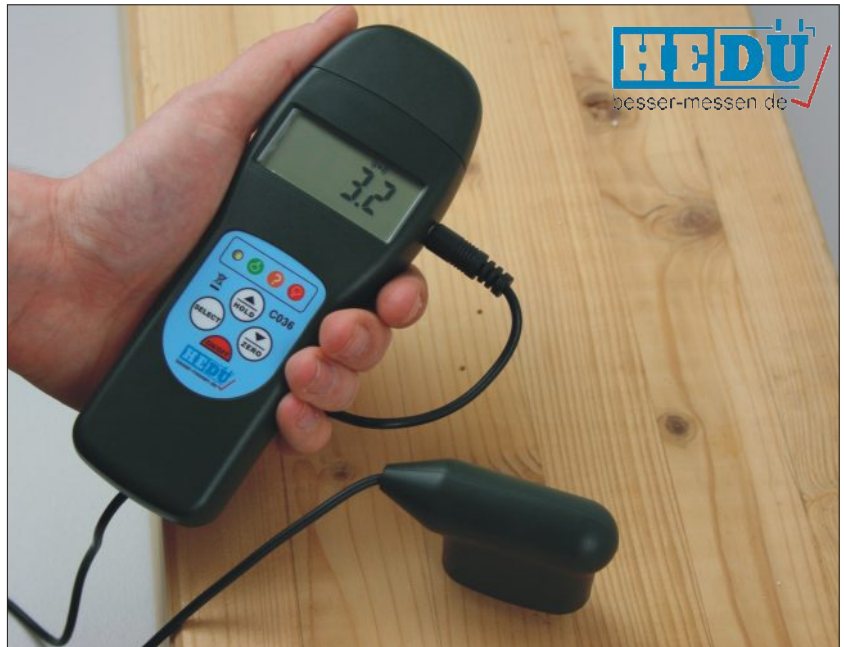
2 w 1: Wilgotno ciomierz oferuje w zestawie czujnik igłowy (rysunek u góry) oraz bezinwazyjn (nieniszcz c ) sond (rysunek na dole).
