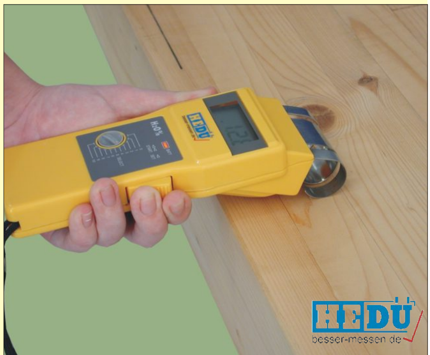
Bezinwazyjny pomiar zawarto ci wilgoci w ró nych rodzajach drewna przez proste przyło enie urz dzenia do powierzchni mierzonego elementu.
