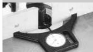
Misurazione del tagliante anteriore.
