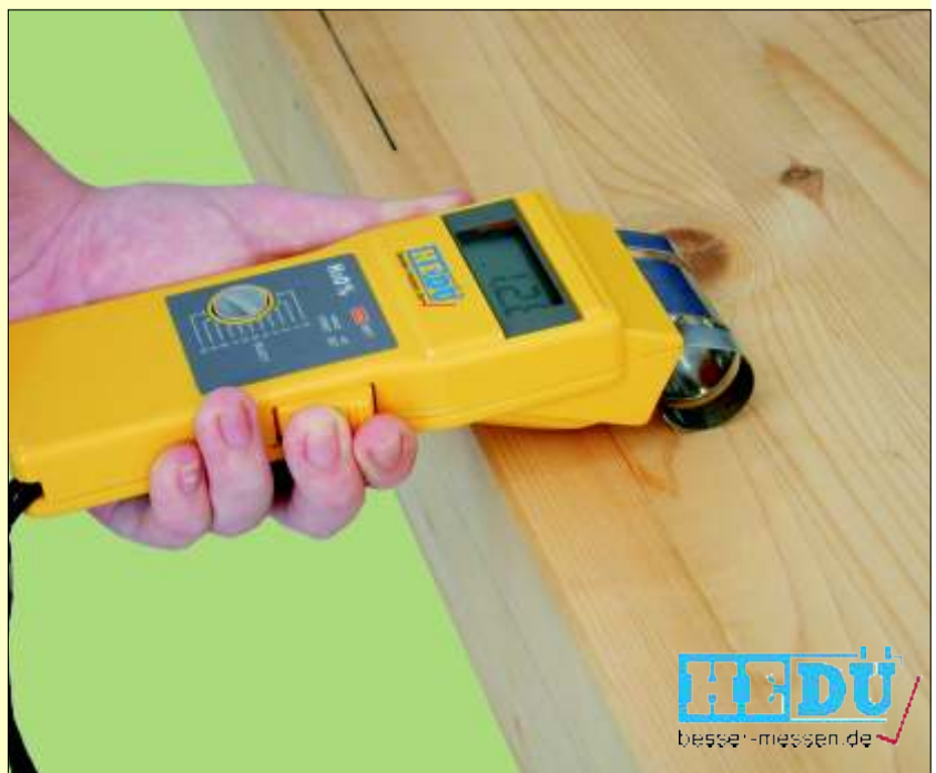
Mesure non destructive de la teneur en humidité dans les bois par simple application sur la pièce.
