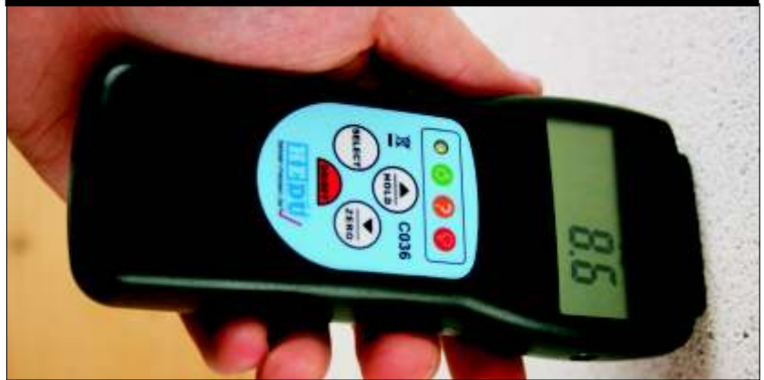
2 en 1: cet appareil est pourvu d'une fonction mesure ponctuelle (photo d'en haut) et d'une fonction recherche non destructive (photo d'en bas).
