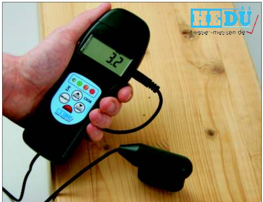
2 en 1: cet appareil est pourvu d'une fonction mesure ponctuelle (photo d'en haut) et d'une fonction recherche non destructive (photo d'en bas).
