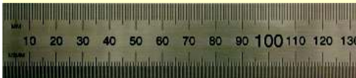
Règles graduées en acier spécial inoxydable. Surfaces mates anti-reflets. Bordure supérieure en mm, bordure inférieure en 1/2 mm.
