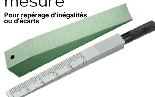
Fig. d'en bas: Coin de mesure, résolution de lecture 0,1 mm, échelle de 0,5 à 11 mm, longueur sans la poignée 130 mm.
