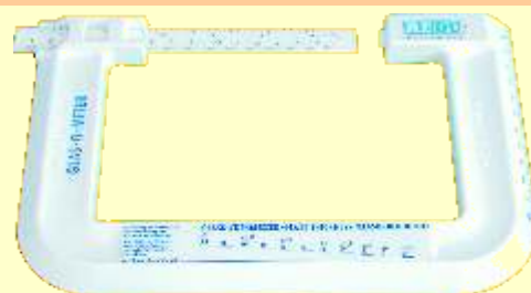
Mesure d'épaisseur de vitre montées sur leur encadrement.
