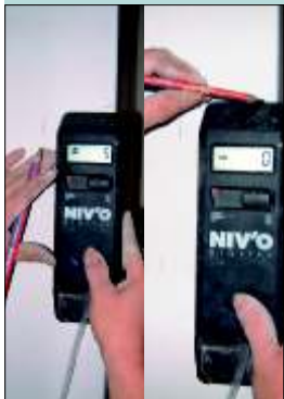
L'écart par rapport au niveau zéro est affiché en mm. Le report du point zéro est extrêmement simple
