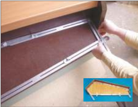
Mit der Winkelschablone kann eine Form, hier eine Stufenform, schnell und exakt nachgebildet werden.
