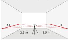
Instrument auf einem Stativ mittig zwischen zwei Wände (A+B) stellen, deren Abstand ca. 5 m beträgt. Lockschalter auf die Stellung "Unlocked" stellen. Instrument auf Wand A richten und einschalten. Horizontale Laserlinie oder Laserpunkt aktivieren und Lage der Linie oder des Punktes auf der Wand (A1) markieren. Instrument um 180° drehen und die horizontale Laserlinie oder den Laserpunkt genau so auf der Wand (B1) markieren.
