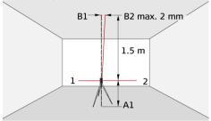
Den Laser auf Stativ oder Wandhalterung nahe Punkt A1 aufbauen, mit einem Mindestabstand von 1,5 m zu Punkt B1. Der horizontale Laser ist in Richtung 1 ausgerichtet. Laserpunkte A1 und B1 mit einem Stift markieren.
