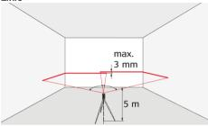
Lockschalter auf die Stellung "Unlocked" stellen. Instrument im Abstand von ca. 5 m von der Wand platzieren. Instrument auf die Wand richten und einschalten. Laserlinien aktivieren und Laserkreuzungspunkt auf der Wand markieren. Instrument nach rechts und anschliessend nach links schwenken. Dabei die vertikale Abweichung der horizontalen Linie von der Markierung beobachten. Wenn die Differenz 3 mm nicht überschreitet, befindet sich der Leica Lino L4P1 innerhalb der Toleranz.
