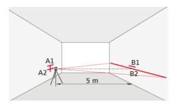
Anschliessend Instrument auf gleicher Höhe möglichst nahe zur Wand A platzieren und erneut die horizontale Laserlinie oder den Laserpunkt auf Wand A (A2) markieren. Instrument wieder um 180° drehen und Laser auf Wand B (B2) markieren. Abstände der markierten Punkte A1-A2 und B1-B2 messen. Differenz der beiden Messungen ermitteln.
